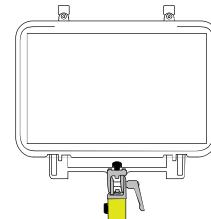
Mit Stativaufnahme\* einfach auf Normstativ montierbar.
